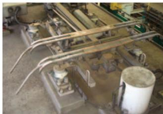
CFRP製パンタグラフ
