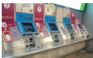
バリアフリー化対応型券売機 (券売機下に車いすのためのけりこみを設置)
