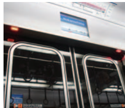
扉開閉予告装置
