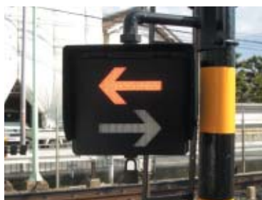
列車進行方向指示器(LED型)
