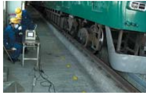
輪重測定装置
