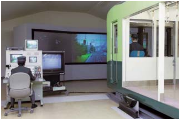
運転シミュレーター（研修所別棟内）
